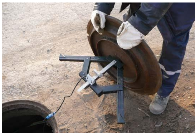
3.15 - сурет – Люк қақпағының құлыптау құрылғысында сенсорды орнату
