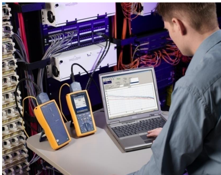
2.1 - сурет – Желі көрсеткіштерін тестілеу және өлшеу
